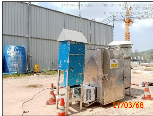
รูปที่ 3.7-3 จุดตรวจวัดระดับความสั่นสะเทือน ประจำเดือนมีนาคม 2568 ที่มา : บริษัท กรีน เอ็นไว เอ็นจิเนียริง จำกัด, 2568
