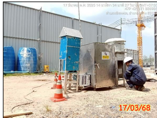
รูปที่ 3.5-3 จุดตรวจวัดคุณภาพอากาศในบรรยากาศโดยทั่วไป ประจำเดือนมีนาคม 2568 ที่มา : บริษัท กรีน เอ็นไว เอ็นจิเนียริง จำกัด, 2568
