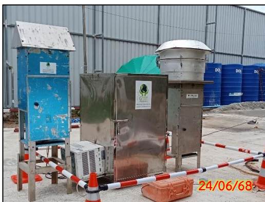
รูปที่ 3.5-6 จุดตรวจวัดคุณภาพอากาศในบรรยากาศโดยทั่วไป ประจำเดือนมิถุนายน 2568 ที่มา : บริษัท กรีน เอ็นไว เอ็นจิเนียริง จำกัด, 2568
